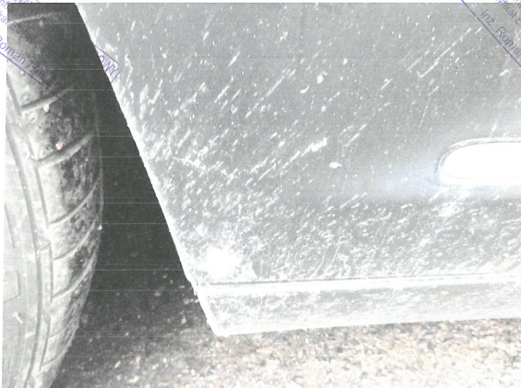
fot. 9 ( ubytek powłoki lakierowej na drzwiach przednich lewych )
