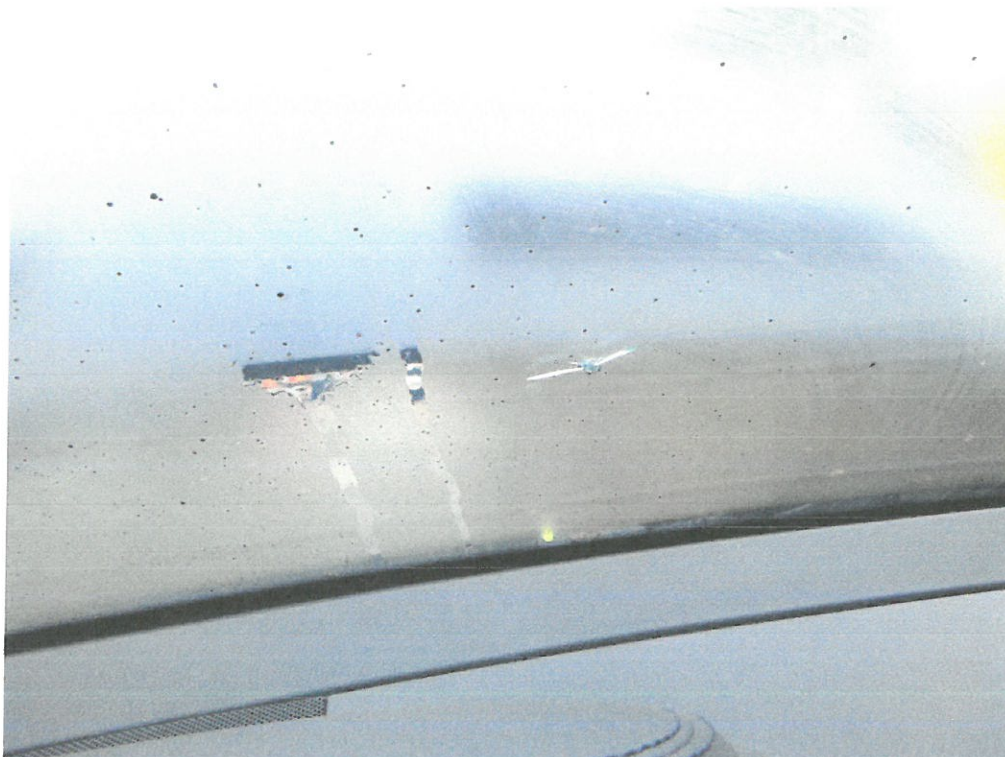
fot. 17 ( pęknięta szyba czołowa )
